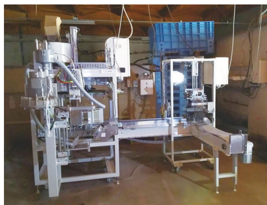
菌床ブロック製造・袋詰め機(上)と菌茸施設(右)
