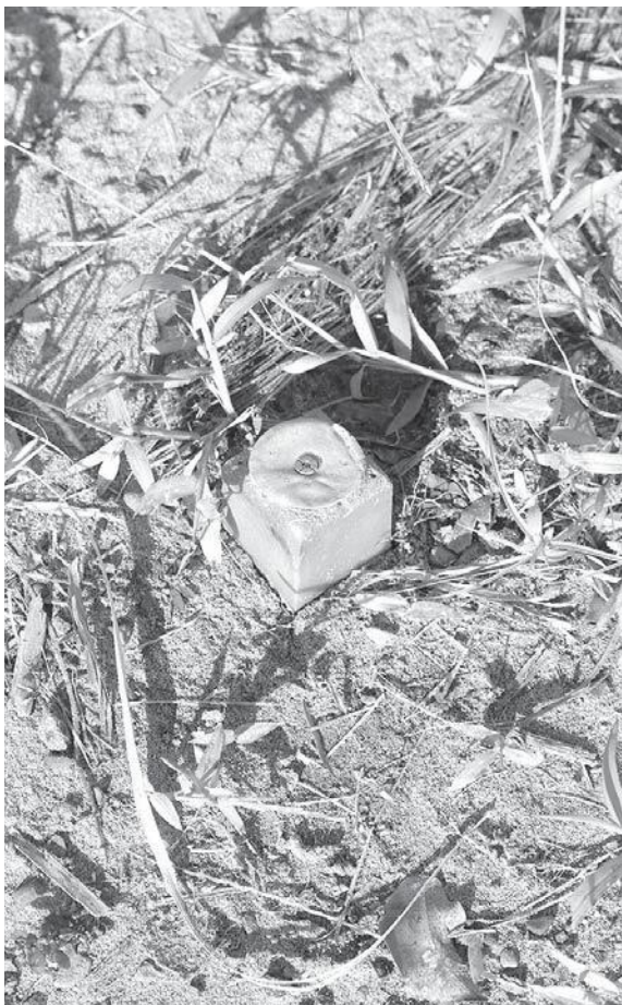
地籍調査で打たれた境界杭。小さいながらも大きな意味を持って立っている
