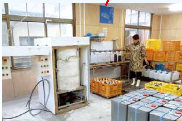
只今、ペットボトルに詰込み作業中です (左手前の培養器で1度に340Lほどを培養)
