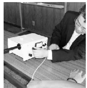
装置の黒い筒の部分を見ると点滅している光が見え、その点滅速度を上げてもらつきを知覚できれば疲労度は低く、逆に知覚できなければ疲労が溜まっていると判断します。
