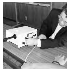
装置の黒い筒の部分を目くると点滅している光が見え、その点滅速度を上げてもちろつきを知覚できれば疲労度は低く、逆に知覚できなければ疲労が溜まっていると判断します。
