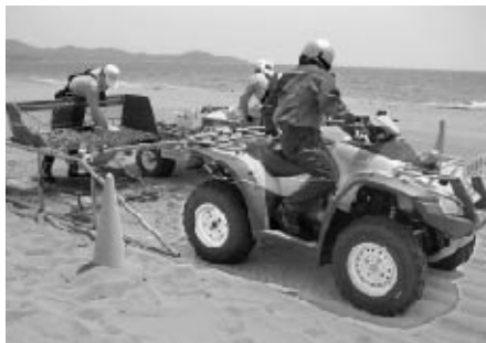
牽引式ビーチクリーナーを取り付けた4輪バギーを走らせて、ゴミを収集します。
