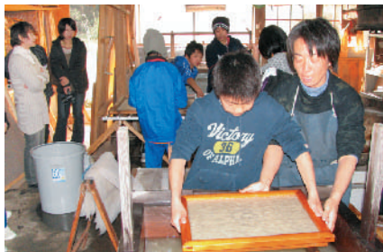
まだらにならないように、できるだけ平面的なかみになるように、型枠を持つ手にも力が入ります。
