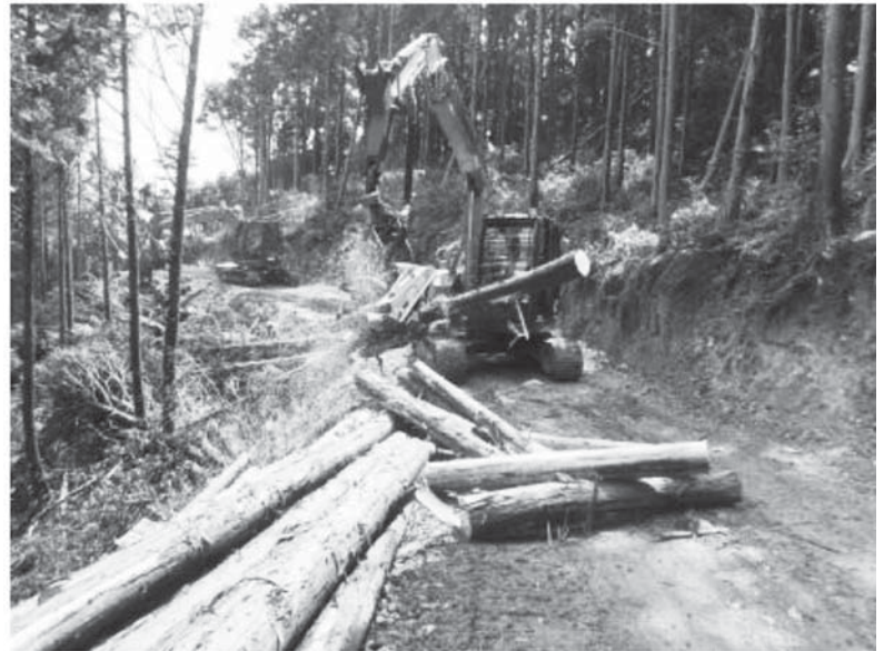
重機についたウインチによる集材作業と 造材機による丸太の裁断作業
